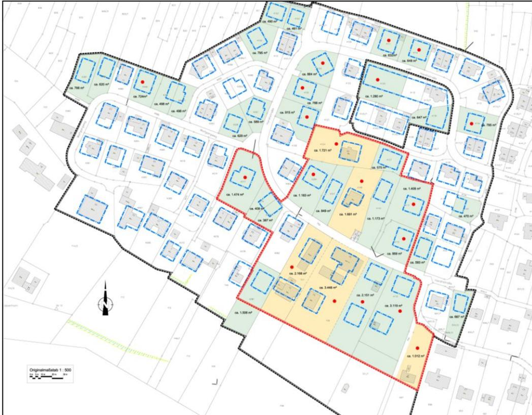
Lageplan mit ausgewiesenen Baufenstern, rot gekennzeichnet sind die ermittelten Potentiale der Nachverdichtung
